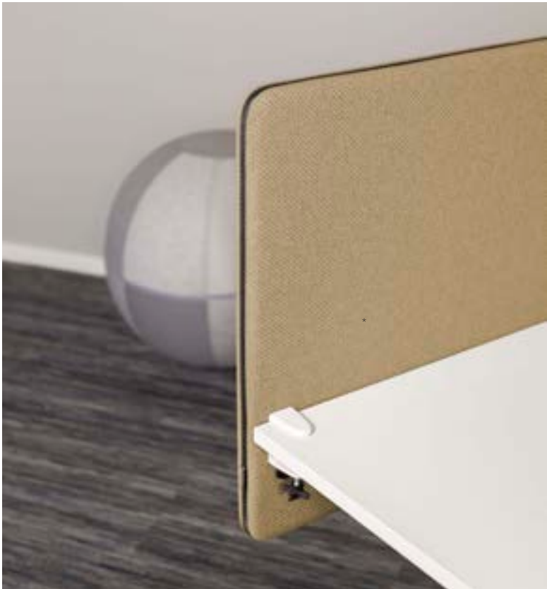
A40 är uppbyggd av en träram fylld med 40 mm skumlaminerad textil för en bra ljudabsorption. Total tjocklek på skärmen är 50 mm. Välj bland en mängd textilier och kombinera med söm eller blyxtlås.
